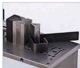
Enges Biegen um den Biegedorn
